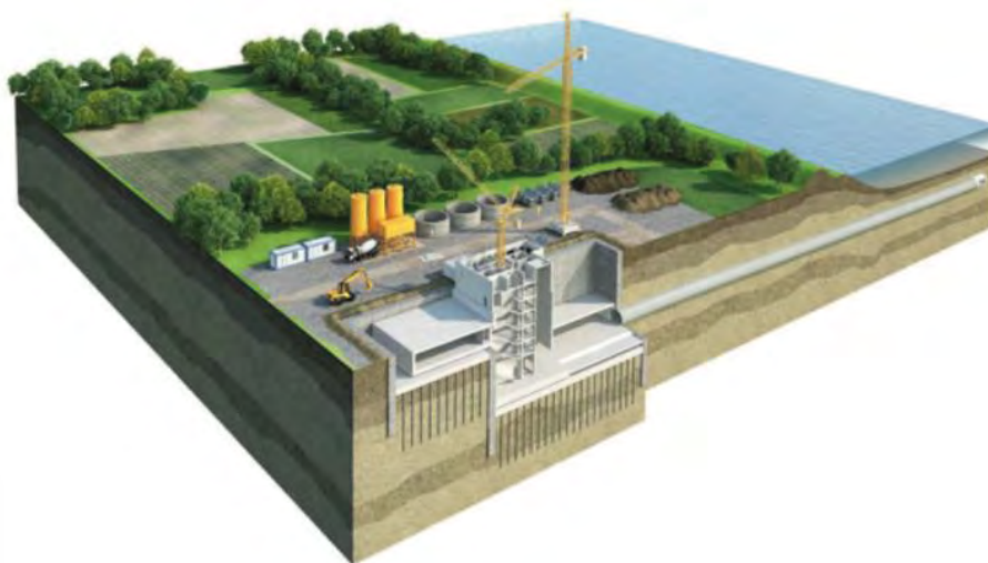
Darstellung der Bauphase Kabeleinzug im ElbX Projekt
